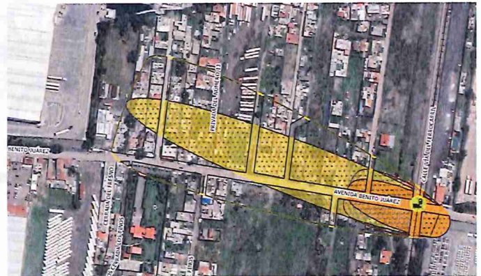
Ilustración 60. Escenario de riesgo de zonas de exposición tóxica a gasolina en carro de tanque ferroviario.
