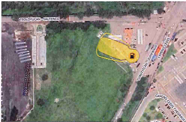
Ilustración 46. Escenario de riesgo de zonas inflamables de estaciones de servicios.
